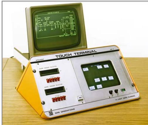
Figura 3: Uno de los primeros terminales táctiles capacitivos del CERN, 1980.
